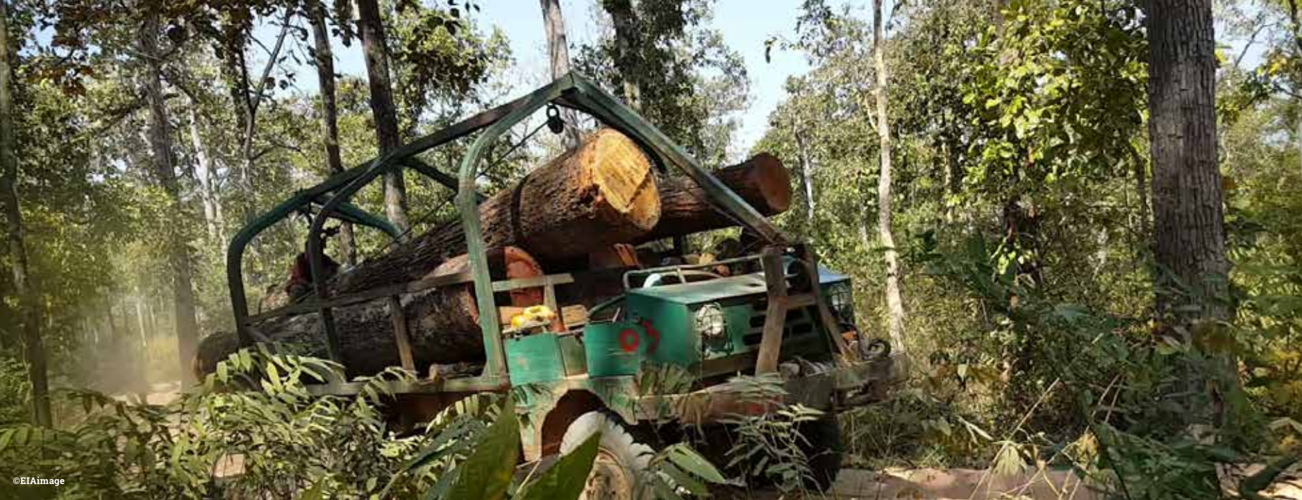
Ảnh trên: Những chiếc xe tải “bò vàng” đang di chuyển chậm chạp, những chiếc xe tải cơ bản, có khả năng chở tới 20 m3 gỗ men theo các con đường mòn trong rừng. Vì được lắp đặt cần trục nên những chiếc xe “bò vàng” này có thể lấy gỗ trực tiếp từ khu vực đốn hạ
